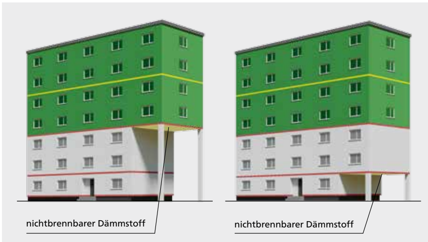
Abbildung 15: Übergänge zu auskragenden Horizontalflächen in der Schutzzone Sockelbrand am Beispiel von Arkaden. Für Untersichten sind ausschließlich WDVS mit nichtbrennbaren MW-Dämmstoffen zugelassen.
