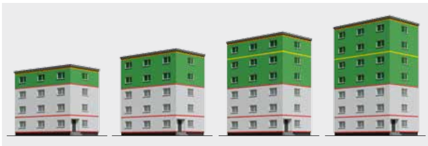
Abbildung 23: Beispiele für die Anordnung von Brandriegeln bei Gebäuden der GK 4 und 5 mit angrenzenden brennbaren Bauprodukten am Dach
