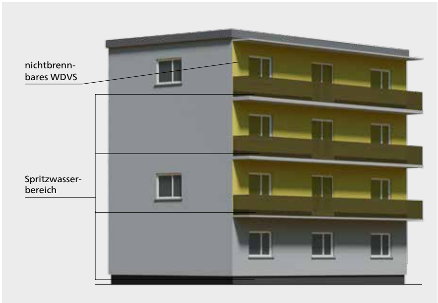
Abbildung 4: Mögliche Ausführung eines WDVS an Laubengängen, die ausgewiesene Fluchtwege sind
