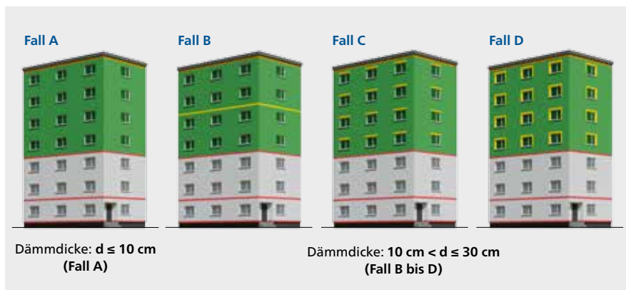
Abbildung 22: Konstruktive Brandschutzmaßnahmen an höheren Gebäuden (beispielhaft)
