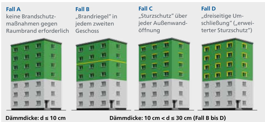
Abbildung 9: Konstruktive Brandschutzmaßnahmen für die Schutzzone Raumbrand im Überblick
