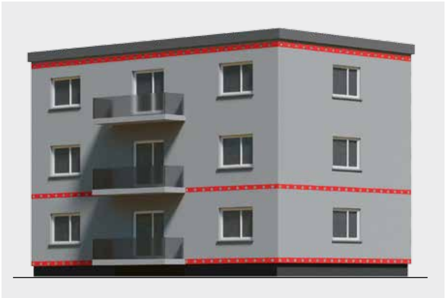
Abbildung 28: Beispielhafte Ausbildung eines Brandriegels unter Einbeziehung einer Balkonkragplatte
