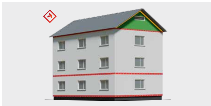
Abbildung 21: 3. Brandriegel in Doppelfunktion auch als Abschlussriegel
