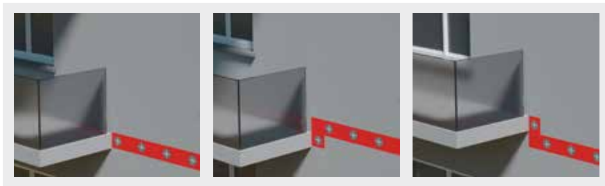
Abbildung 29: Varianten des seitlichen Anschlusses eines Brandriegels an eine Kragplatte
