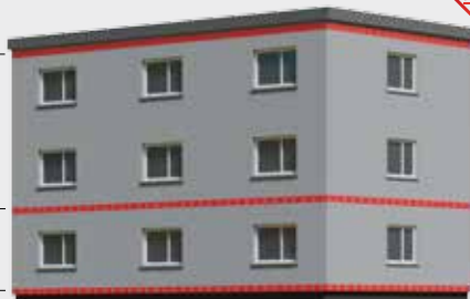
Abbildung 18: Beispielhafte Ausführung der Brandschutzmaßnahmen bei einem brennbaren Flachdach
