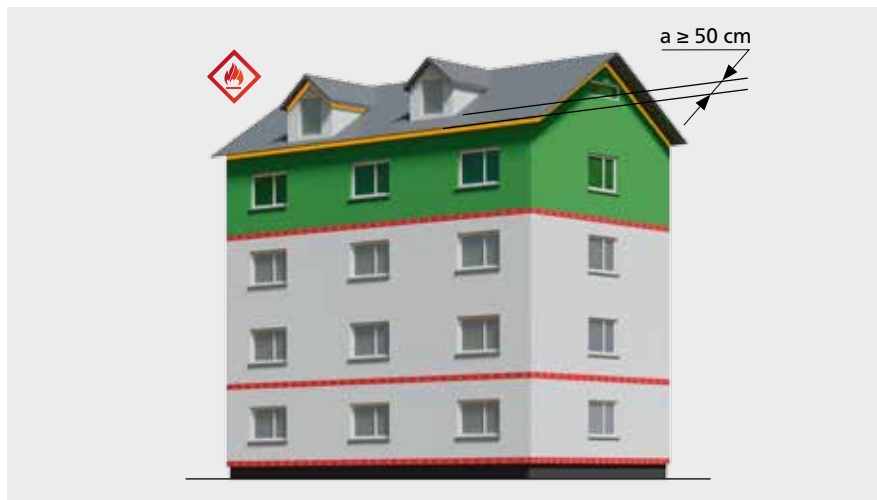
Abbildung 20: Ausführung von Abschlussriegeln unterhalb eines „ausgebauten“, brennbaren Steildaches mit Aufenthaltsräumen und Dachgauben, die mit EPS-WDVS gedämmt sind
