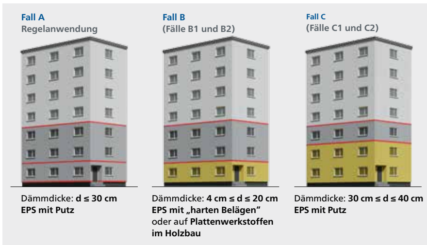
Abbildung 10: Konstruktive Brandschutzmaßnahmen für die Schutzzone Sockelbrand im Überblick
