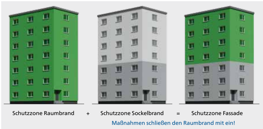
Abbildung 8: Brandschutztechnische Schutz zonen an Fassaden
